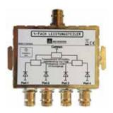
"1 in 4" schmalbandiger Wilkinsonteiler für den Frequenzbereich 823 ~ 832 MHZ; Besonders geringfügige Einfügungsdämpfung von max. 7 dB; HF-Entkoppelung zwischen den 4 Ausgängen besser als 22 dB; DC-Durchgang für Aktivantennen
