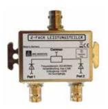
"1 in 2" schmalbandiger Wilkinsonteiler für den Frequenzbereich 823 ~ 832 MHZ; Besonders geringfügige Einfügungsdämpfung von max. 3,3 dB; HF-Entkoppelung zwischen den 2 Ausgängen besser als 22 dB; DC-Durchgang für Aktivantennen
